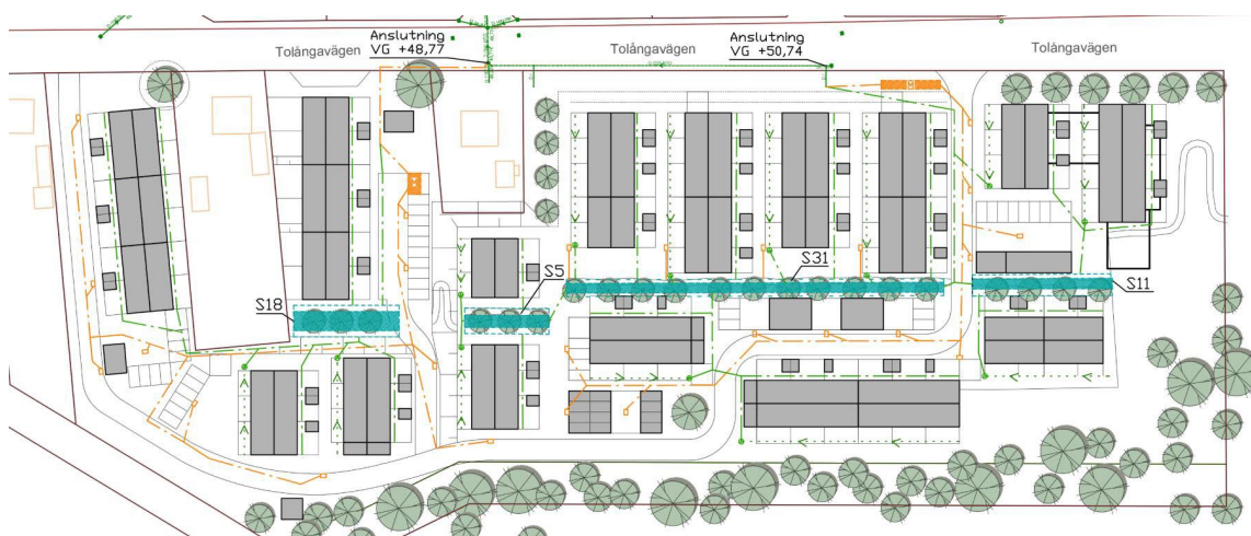
Bild hämtad från dagvatten- och skyfallsutredningen. Infiltrationsmagasin i turkost och täta magasin i orange.
