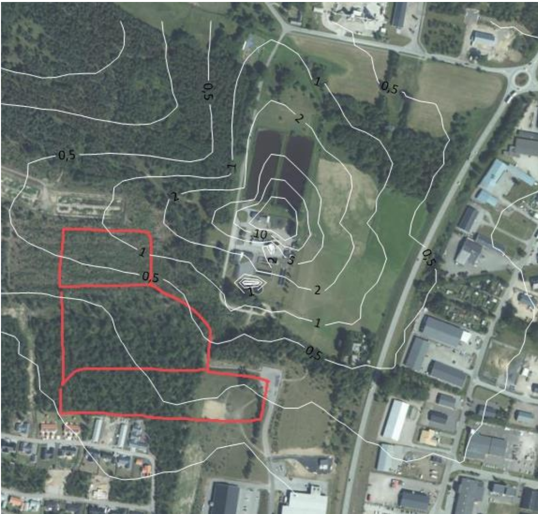
Figur 8 Spridningsberäkning av åtgärdsscenario 2 där luktconcentration (LE/m 3 ) presenteras som 99e percentilen av minutmedelvärden beräknade från timmedelvärden. Detaljplanen är markerad med röd linje.
