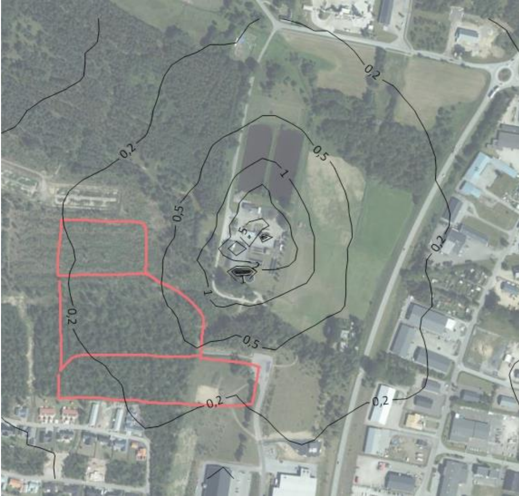
Figur 4 Spridningsberäkningar av lukt från avloppsreningsverket för ett scenario där åtgärd 2 och 3 genomförs. Varje isolinje motsvarar en luktkoncentration i enheten LE/m 3 .
