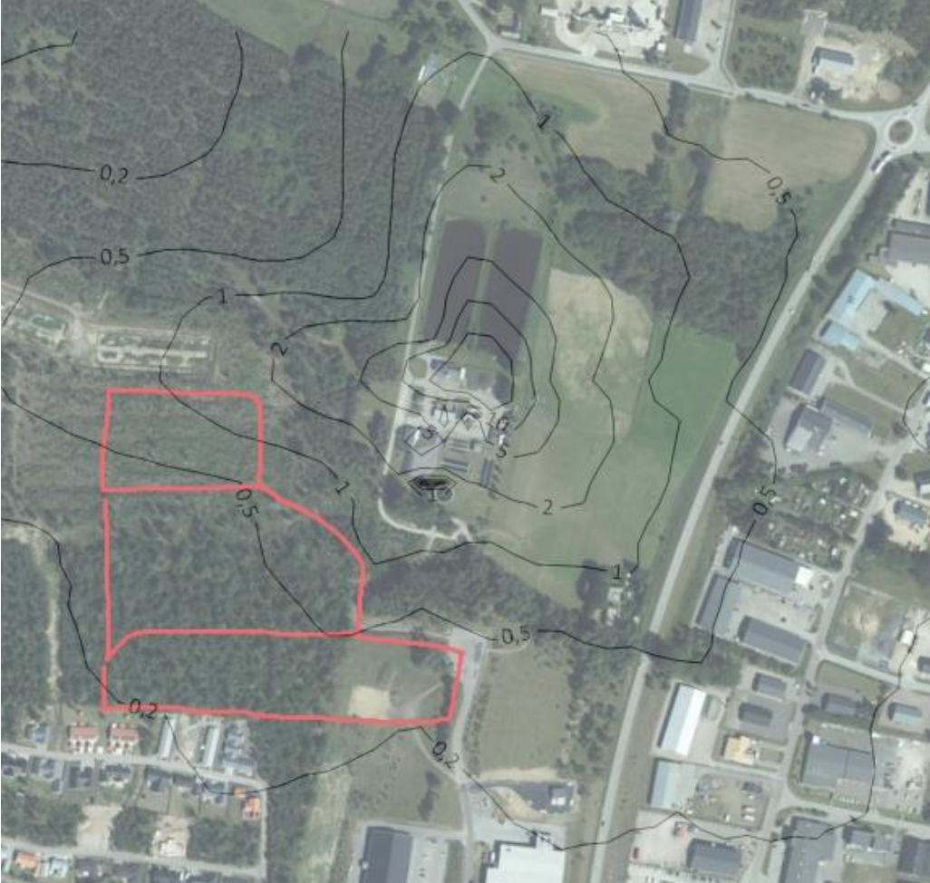
Figur 2 Spridningsberäkningar för ett scenario där endast åtgärd två genomförs. Varje isolinj motsvarar en luktconcentration i enheten \text{LE}/\text{m}^3 .
