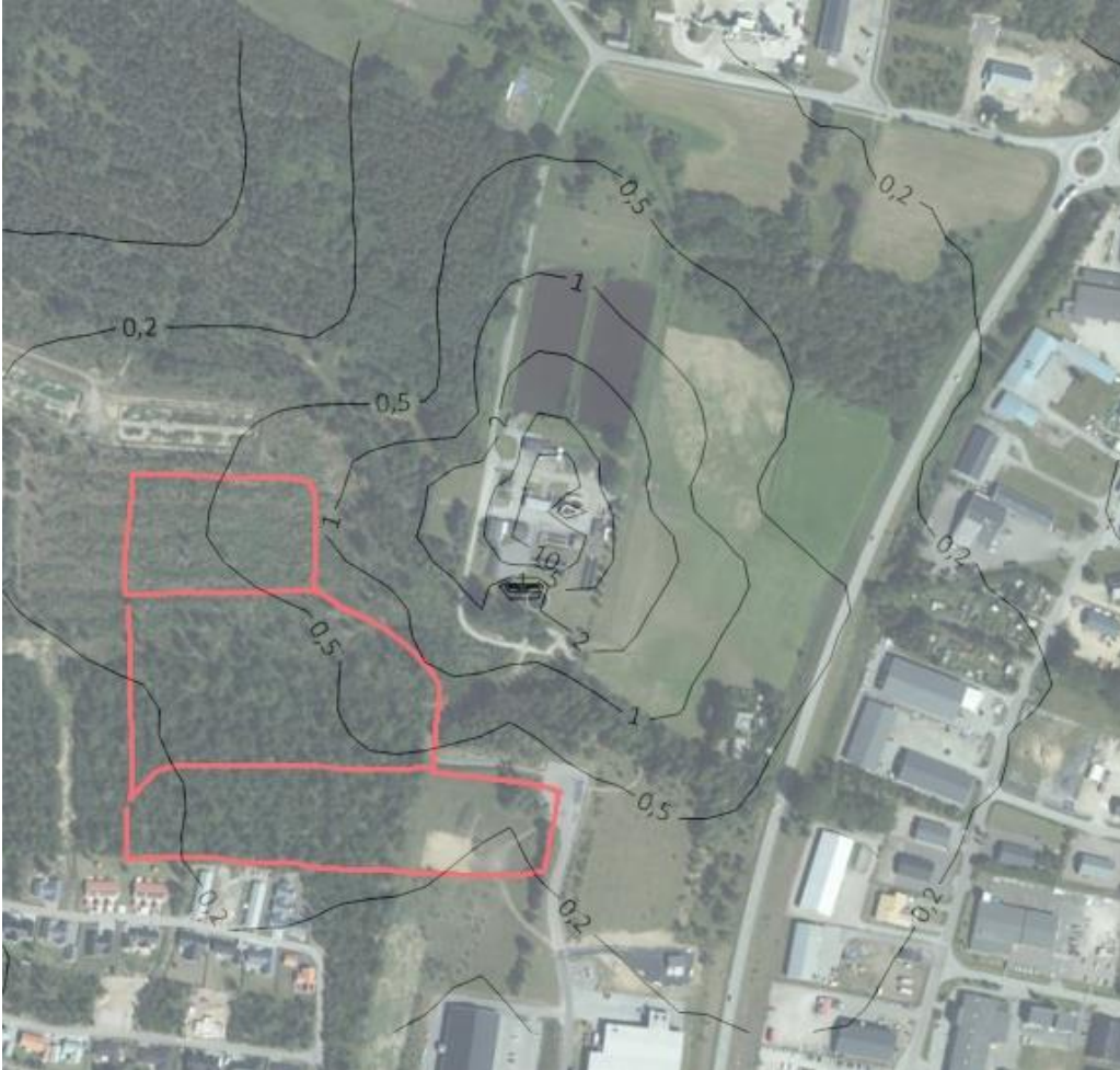
Figur 3 Spridningsberäkningar av lukt från avloppsreningsverket för ett scenario där åtgärd 1 och 3 genomförs. Varje isolinje motsvarar en luktconcentration i enheten LE/m 3 .
