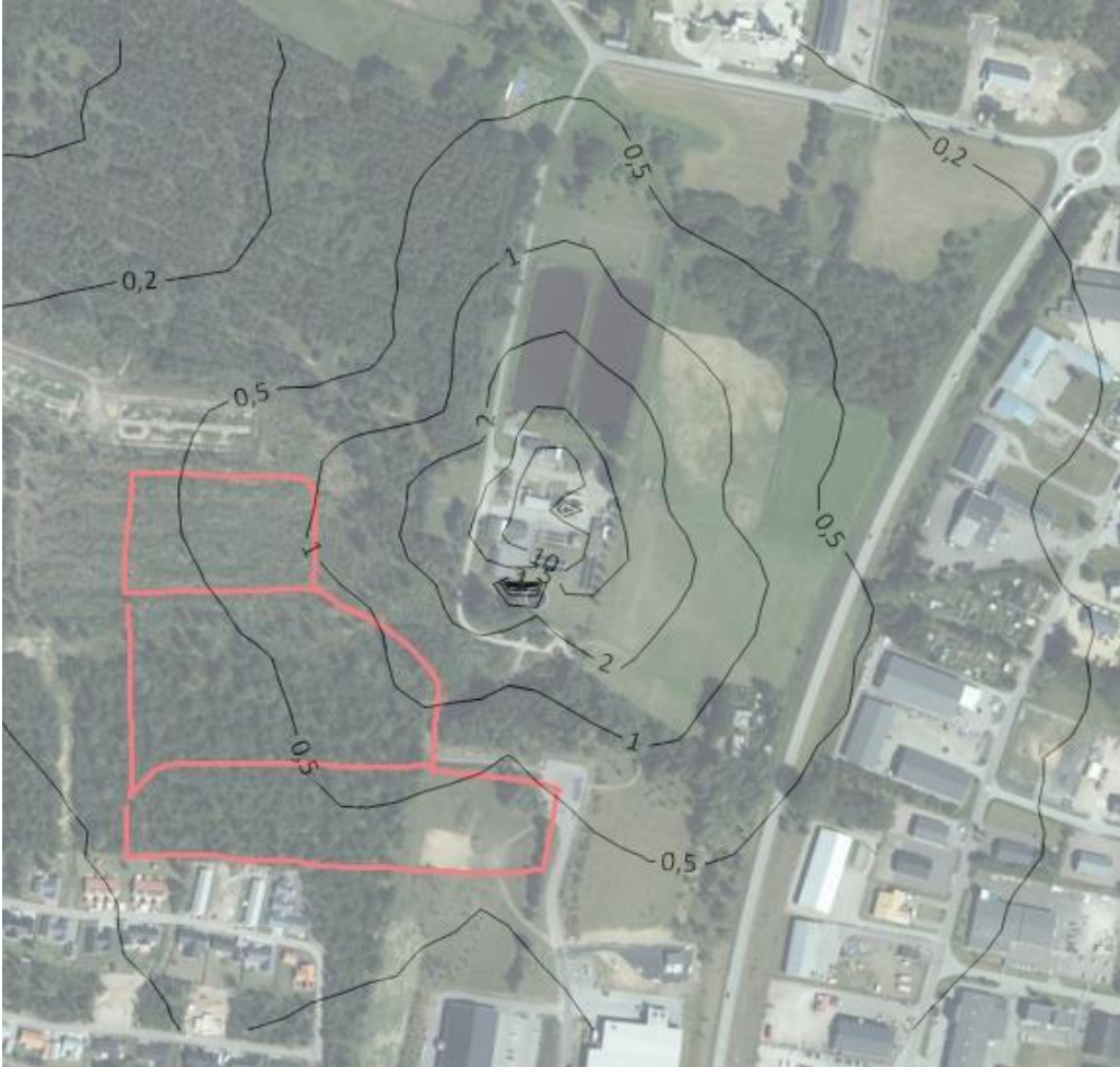
Figur 1 Spridningsberäkningar för scenario 3 där endast slamlagret täcks. Varje isolinje motsvarar en luktkoncentration i enheten LE/m 3 .
