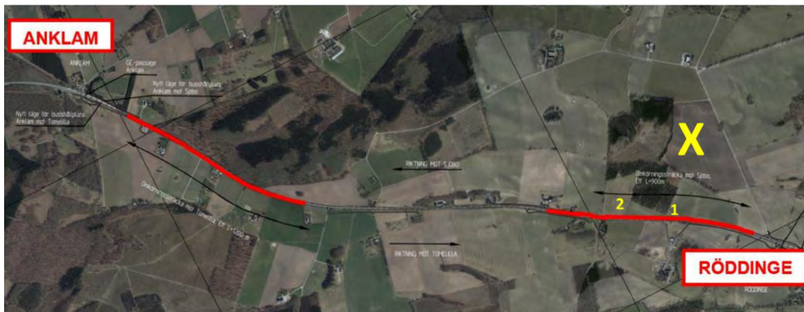
Figur 14: Planerad förläggning av omkörningssträckor väster om Röddinge, tänkt anläggningslokalisering samt de två alternativa tillfarterna (källa: Trafikverket, bearbetning WSP)
